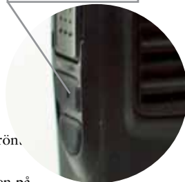
KANALSÖKNING / SPARA KANAL
